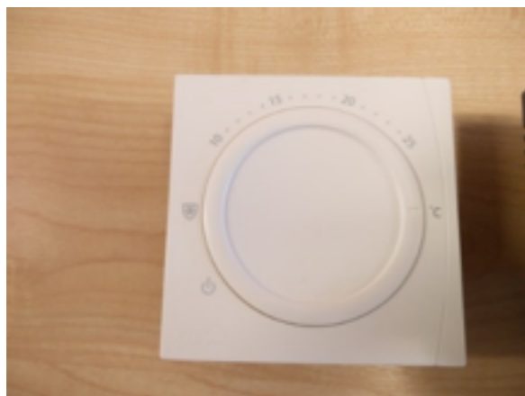
Põrandaküttetermostaat Tootja: Danfoss
